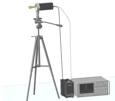
Рис. 4 Антенна П6-134 с преобразователем частоты СК5РТ 50-60/3-18 WR19 (60-75/3-18 WR12)
