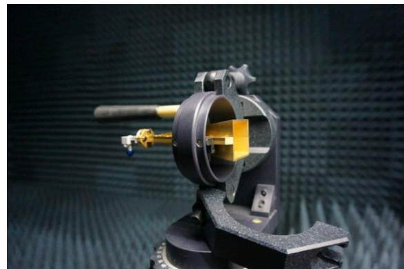
Фото 2. Антенна П6-134 на диэлектрическом штативе ШАД-01
