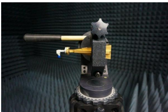
Фото 1. Антенна П6-134 на диэлектрическом штативе ШАД-01
